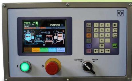
Оригинальная современная система управления позволяет в реальном времени на цветном дисплее визуализировать значения основных технологических параметров – расход и соотношение компонентов, масса заливки, температура и давление.
