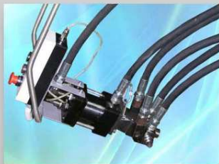
Смесительный узел высокого давления для приготовления двухкомпонентных полиуретановых смесей
